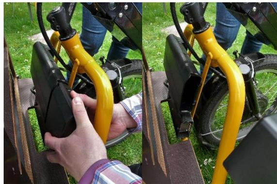
Bitte lagert den Akku trocken und kühl! Schließt den Akku an das Ladegerät und dieses an den Strom an.
