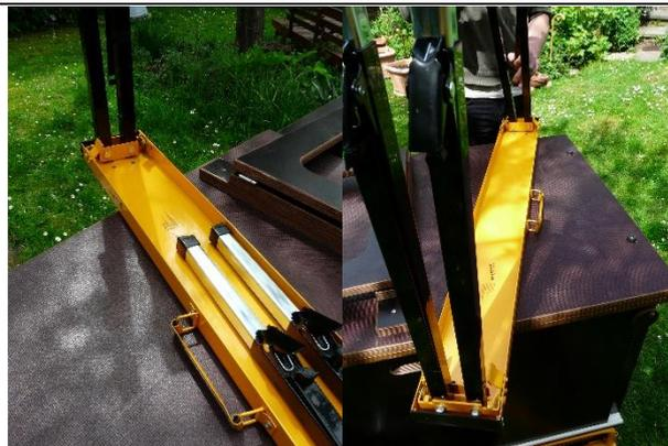
Um die Beinpaare für einen festen Stand zu justieren, klappt die Beine bis zum Anschlag an die kurze Metall-Außenseite und bewegt ein Bein nach rechts und ein Bein nach links. Sie müssen sich hinter den gelben Metallstücken einklemmen.
