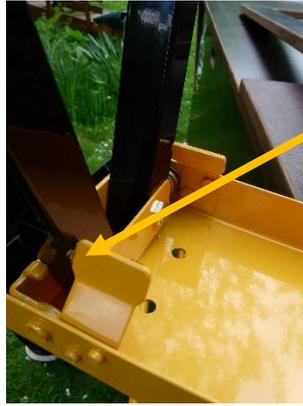
Sichert die Beine mit der Querverstrebung. Klappt die Verstrebung hin zum gegenüberliegenden Bein und dreht die Verstrebung mit der Schraube handfest.
