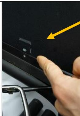
Sichert den Windschutz mit kleinen Flügelschrauben. Dreht diese von außen nach innen ein. Damit kann der Windschutz nicht mehr abgezogen werden.
