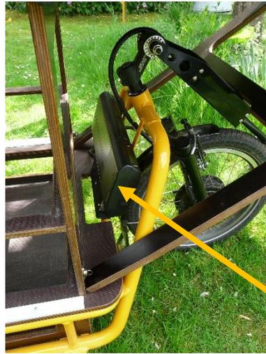
Um den Akku zu entnehmen, steckt den Schlüssel von unten in den silbernen metallischen Schloßzylinder. Dreht den Schlüssel um 180°.
