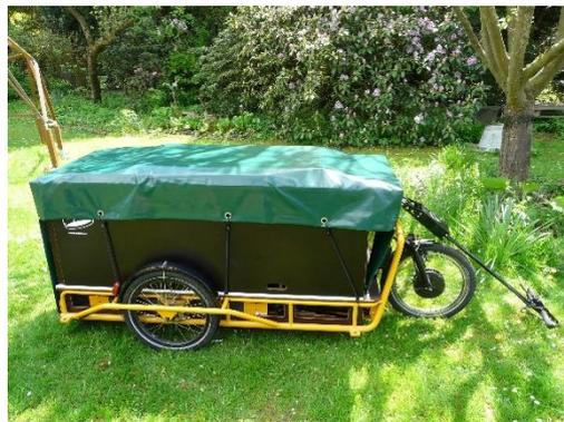
Zieht Pepe an den Griffen der Deichsel (über dem Vorderrad) auf eine möglichst ebene Fläche/auf einen Weg. **Achtung: Feststellbremse (den roten Hebel an der Bremse) lösen! Zieht den Bremshebel dafür bis zum Anschlag und kippt den roten Hebel aus der Einrastung heraus.**
