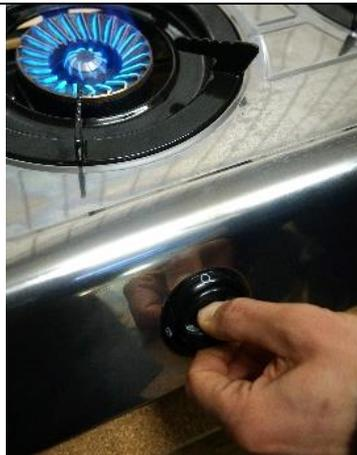
Die Einstellung der Flamme und Hitze funktioniert stufenlos. Bei starker Hitze zeigen beide Ringe eine Flamme, bei geringer Hitze nur der innere Ring.
